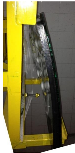
Fig. 12 – vista lateral da fixação da janela no suporte.
