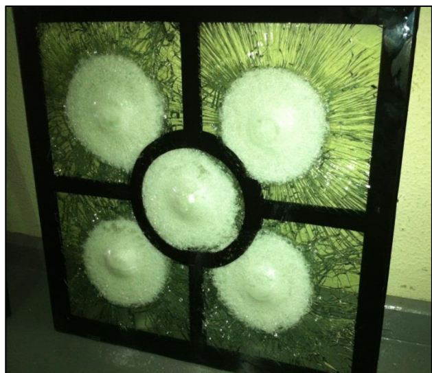
Fig. 06 - face oposta de um corpo de prova de 500x500mm, após os cinco disparos.
