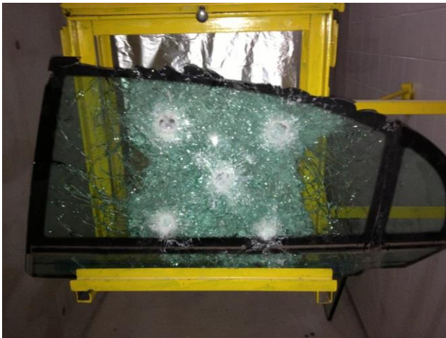
Fig. 09 – disparos executados em vidro balístico de uma janela de veículo.
