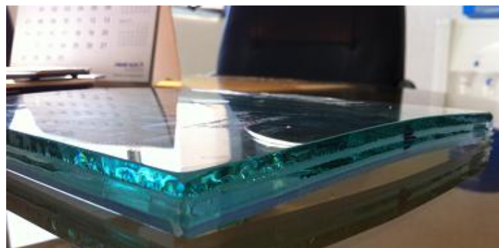
Figura 3.3 – CDP's curvos foram concebidas com raio de 2500 mm.
