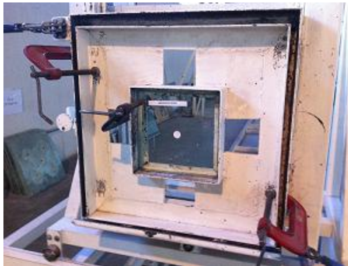
Figura 3.1- Dispositivo de fixação dos CDP's mostrando ângulo de impacto de 90° da trajetória do projétil.
